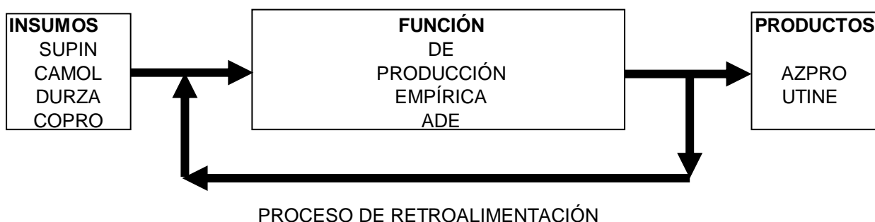
Figura 1. El proceso de producción de la agroindustria azucarera
